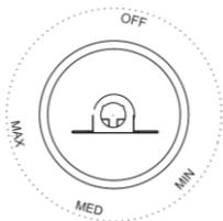
Установка ручки на «MIN-MED-MAX» регулює температуру всередині приладу відповідно від найтеплішої до найхолоднішої
