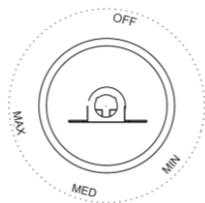
Установка ручки на «MIN-MED-MAX» регулирует температуру внутри прибора соответственно от самой теплой до самой холодной
